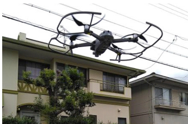
ドローンを使って屋根を診断
