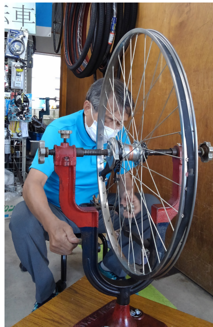
タイヤを限りなく真円に近づけ、歪みをなくすることで、ペダルをこぐ力を軽減し、安全に走行できるようになる
